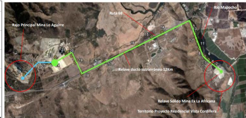
Trazado relave-ducto Mina La Africana – Mina Lo Aguirre (y acueducto retorno de agua clara), longitud 12 km:
